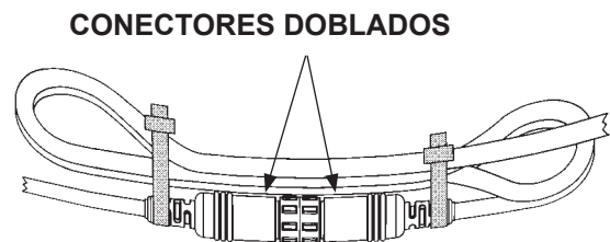
ALINEAMIENTO INCORRECTO DEL CABLE FIG. 57-3
