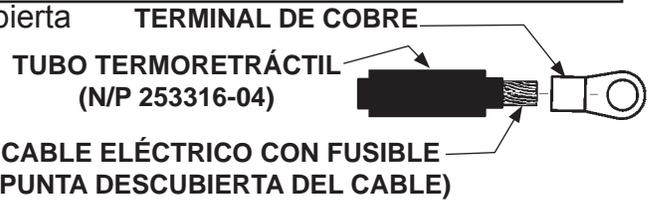
**COLOCAR LA TERMINAL DE COBRE Y EL TUBO TERMORETRÁCTIL EN EL CABLE DE ALIMENTACIÓN ELÉCTRICA CON FUSIBLE**
