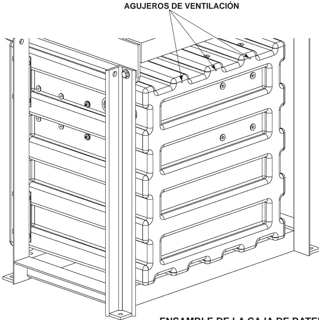
ENSAMBLE DE LA CAJA DE BATERÍA
