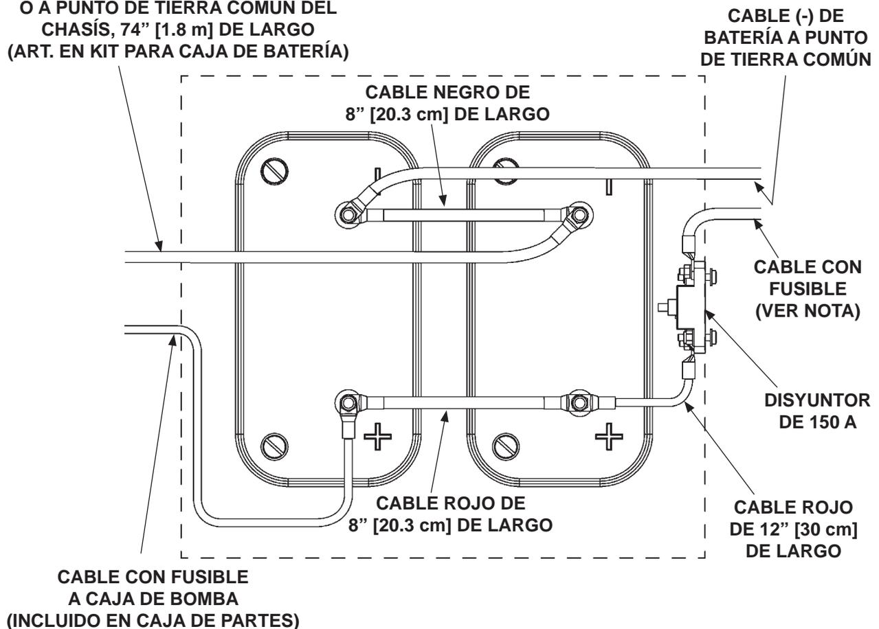
CONEXIONES DE BATERÍA DE 12 V
