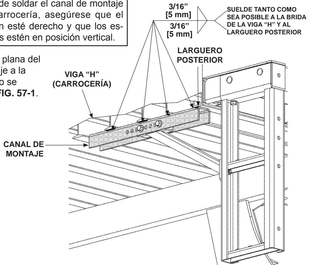
**SOLDAR LA PARTE PLANA DEL CANAL DE MONTAJE A LA CARROCIERÍA (SE MUESTRA ESCALÓN DOBLE IZQUIERDO)**
