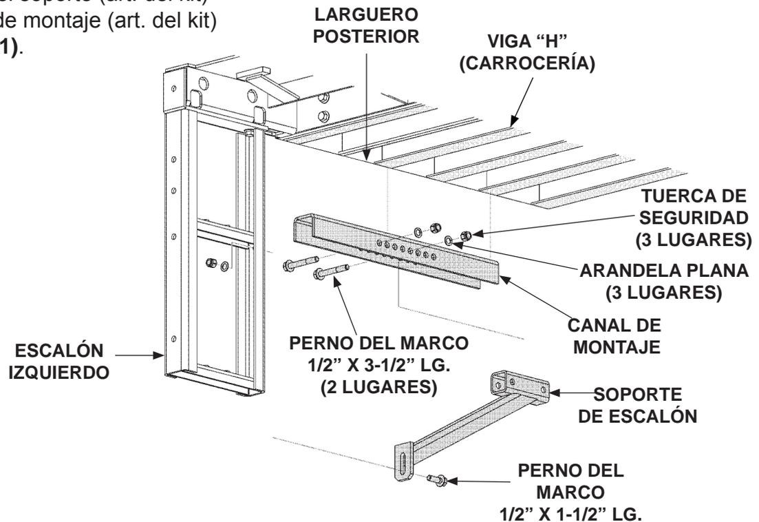
**ATORNILLAR EL SOPORTE AL CANAL DE MONTAJE Y AL ESCALÓN (SE MUESTRA ESCALÓN Y SOPORTE IZQUIERDO)**
