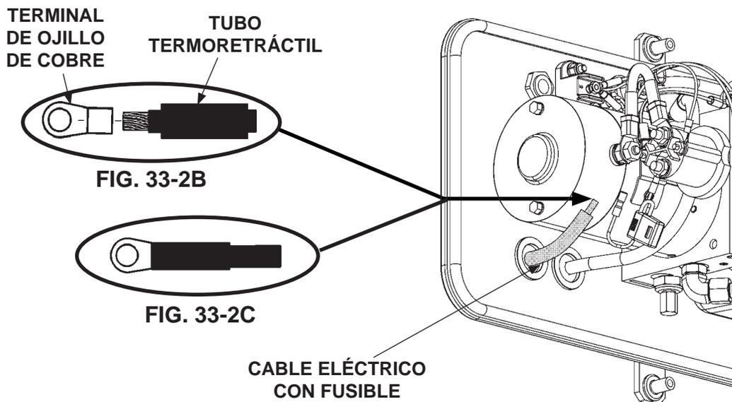
INSTALACIÓN TÍPICA DEL CABLE ELÉCTRICO CON FUSIBLE - BOMBA INDIVIDUAL
