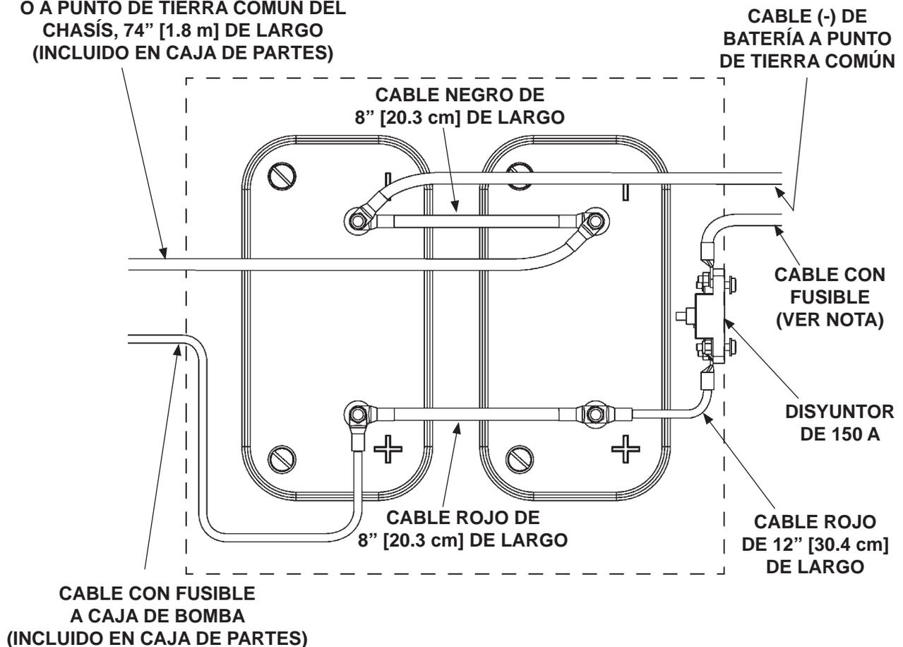
CONEXIONES DE BATERÍA DE 12 V
