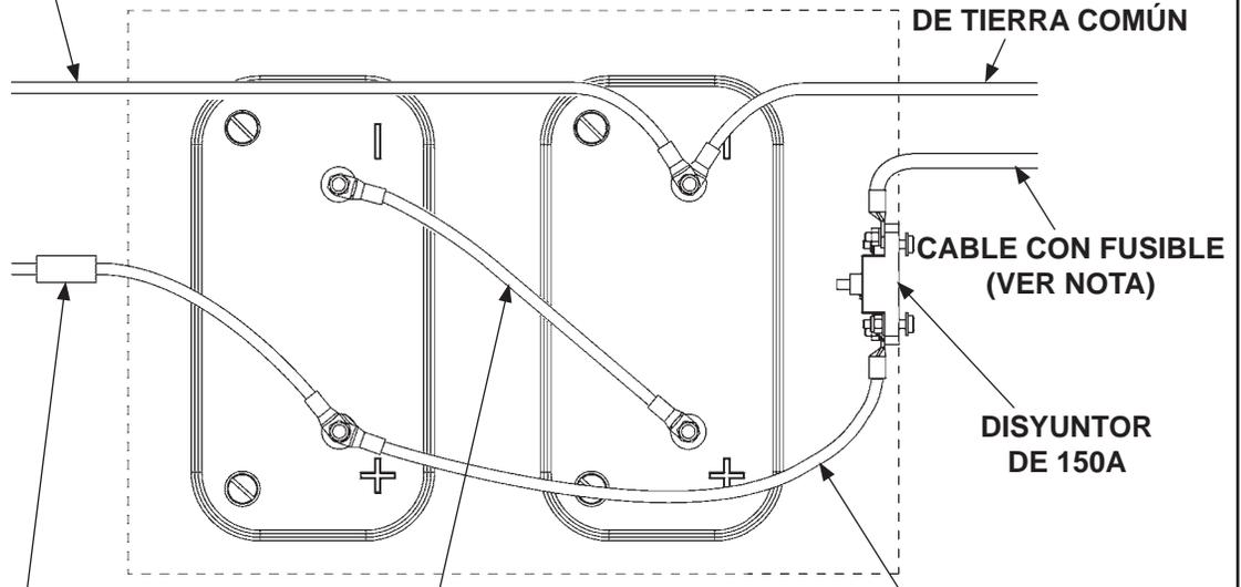
CONEXIONES DE BATERÍA DE 12 V PARA UNA ENERGÍA DE 24 V
