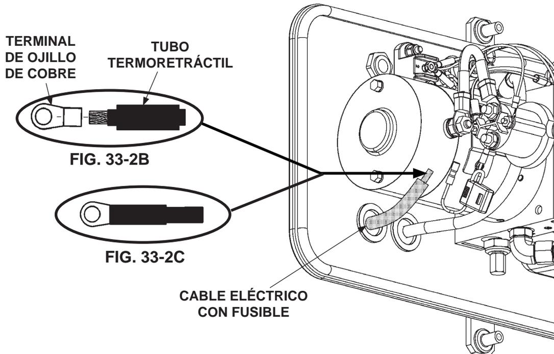
INSTALACIÓN TÍPICA DEL CABLE ELÉCTRICO CON FUSIBLE
