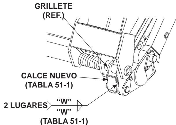
3. Suelde los calces (art. en bolsa de partes) en ambos toques de la plataforma (**FIG. 51-3**) para elevar el borde de la plataforma a la posición correcta.
