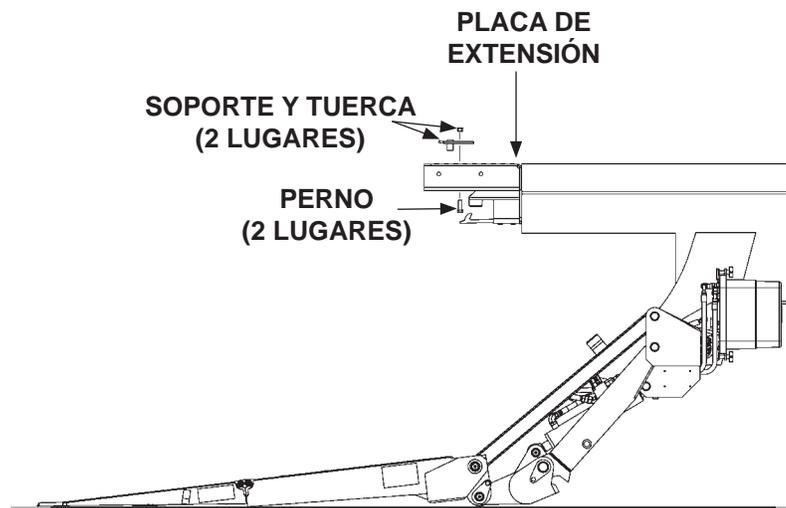
REMOVER LOS SOPORTES DE INSTALACIÓN
