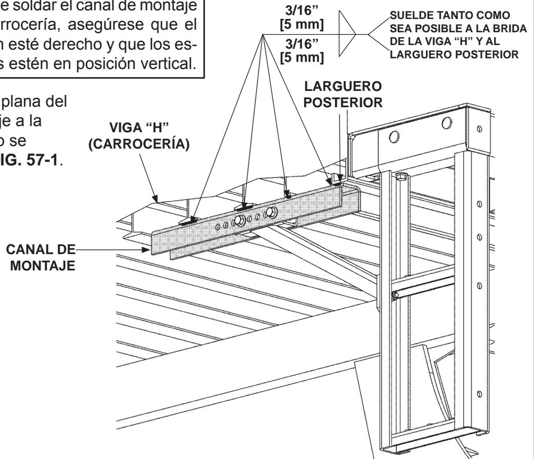
**SOLDAR LA PARTE PLANA DEL CANAL DE MONTAJE A LA CARROCERÍA (SE MUESTRA ESCALÓN DOBLE IZQUIERDO)**
