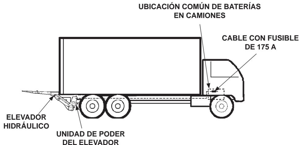
**INSTALACIÓN RECOMENDADA DEL ELEVADOR Y DEL CABLE DE ALIMENTACIÓN ELÉCTRICA EN CAMIONES**
