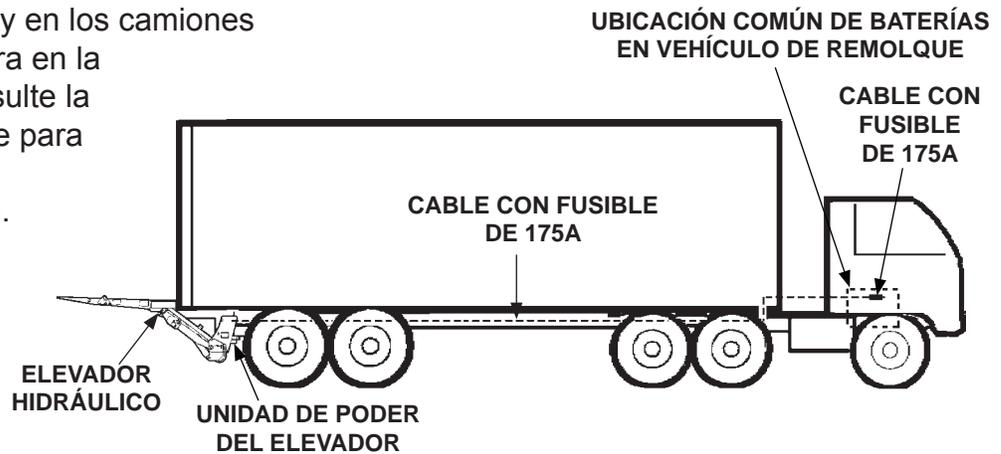
**INSTALACIÓN RECOMENDADA PARA EL ELEVADOR Y EL CABLE DE ALIMENTACIÓN ELÉCTRICA EN TRÁILERES**
