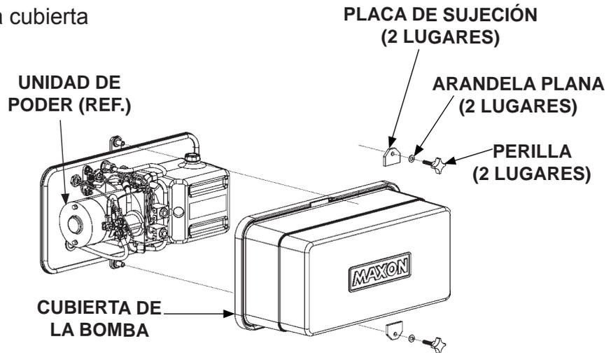
DESATORNILLAR LA CUBIERTA DE LA BOMBA
