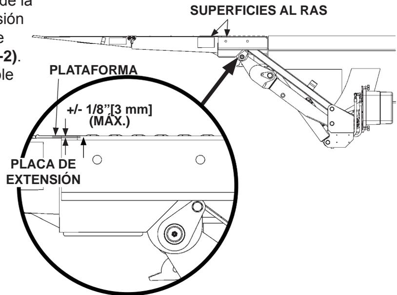
DIFERENCIA EN ALTURA PARA LA PARTE SUPERIOR DE LA PLATAFORMA Y LA PLACA DE EXTENSIÓN (VISTA DERECHA)
